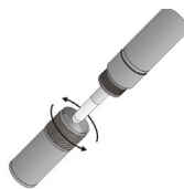
Replace membrane cap
